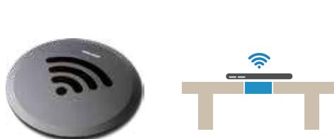
Se instala como un pasacables, se agujerea el material con una broca corona de Ø80 mm. y se coloca el cargador inalámbrico Fi80 alimentado por cable USB. Fi80 dispone de una embellecedor resistente a humedades y polvo.
