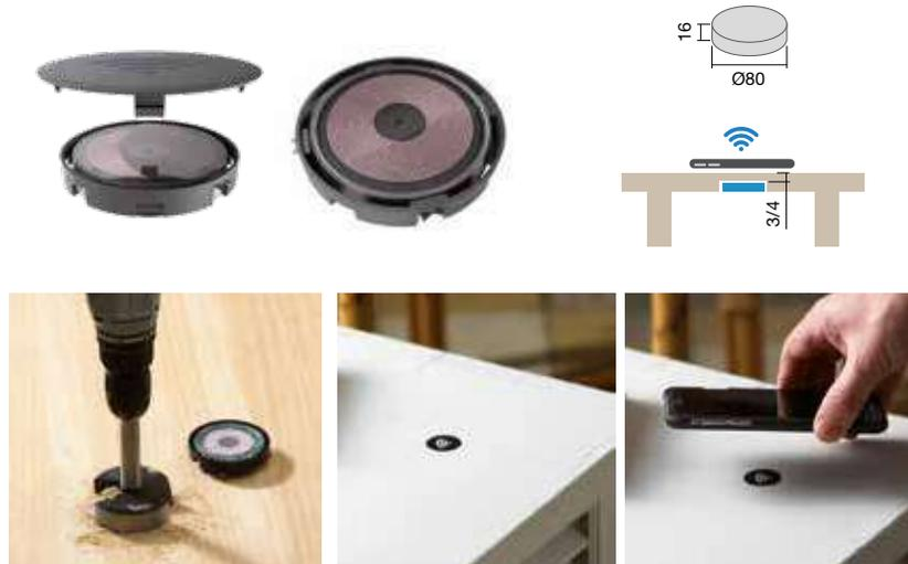
Se debe perforar la parte inferior del mueble o mesa hasta un máximo de 3-4 mm. de la parte superior. Se prescinde de la tapa y se coloca en la parte inferior del mueble o mesa. Fi80 se suministra con un adhesivo para identificar donde colocar el smartphone en la instalación invisible y tapar así, el agujero de la punta centradora de la broca.
