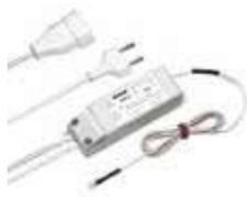
El sensor EBS 4 es un interruptor por contacto. Funciona a 230V conectado a la corriente de forma directa. Se coloca antes de la fuente de alimentación y sirve para dar o no corriente a la instalación. Se sirve con 1 mt. de cable a corriente y 2 mts. de cable hasta la fuente de alimentación.
